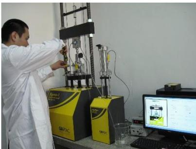
恒应变速率固结仪
