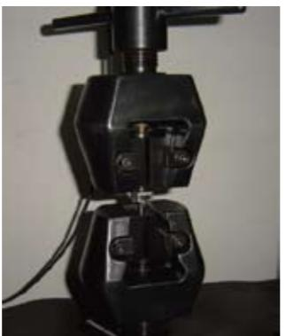
绕丝筛套单点焊接强度检测
