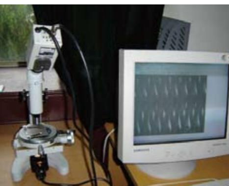
金属网布过滤精度检测
