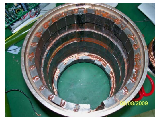
非接触耦合器外筒结构（副边）
