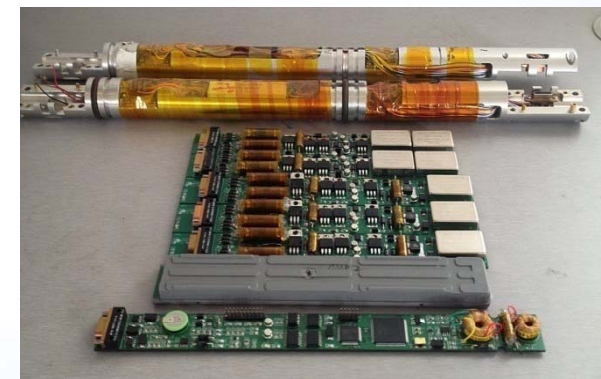
定向探管测量传感器模块
