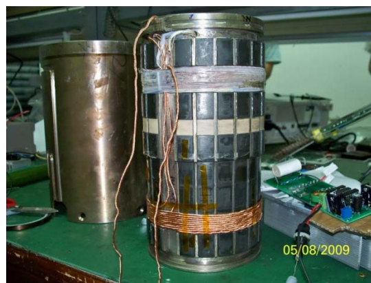
非接触耦合器内筒结构（原边）
